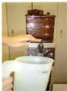
6. 從抽酒閥抽一半的水，打開電源，再推管嘴洗淨內部，流出來的水用容器接。
